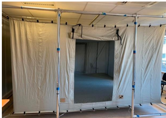
Figure 1. Photographie de la VIRC surélevée par rapport au sol installée au CRT Cisteme (Limoges)
